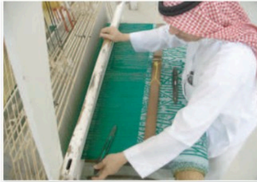
الشكل ( ٦ ) : نلاحظ كيف يمرر النساج المكوك .
