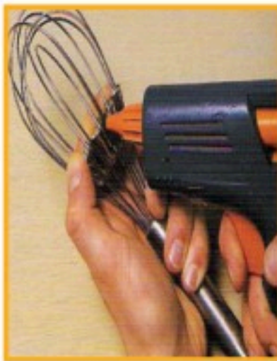
الشكل (٤٦): النوع الثاني (لحام البارد باستخدام الصمغ).
