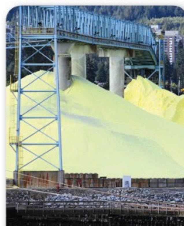
الشكل 1-16 الكبريت يتم استخراج الكبريت من منتجات البترول بواسطة عمليات كيميائية، كما يستخرج بدفع الماء الساخن إلى أماكن تجمعته تحت الأرض، فيُضخ الكبريت السائل إلى السطح.
