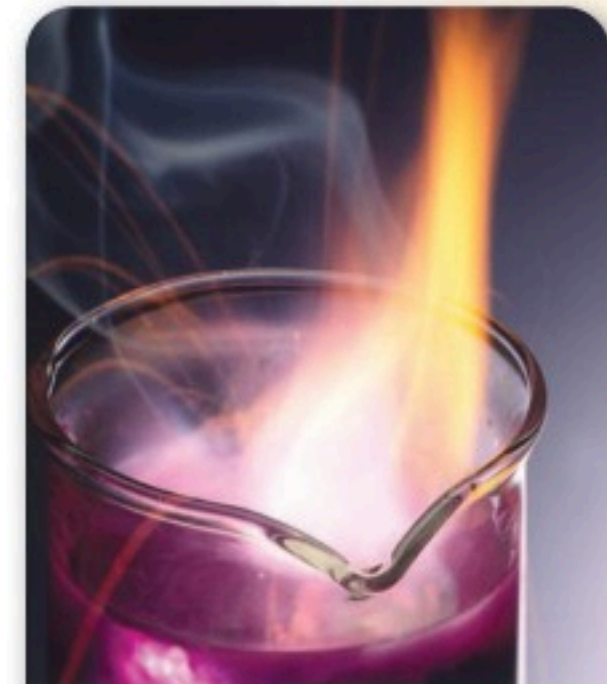
الشكل 1-10 يتفاعل فلز البوتاسيوم بشدة مع الماء مطلقاً كمية كبيرة من الحرارة كافية لإشعال غاز الهيدروجين الناتج واحتراقه.
