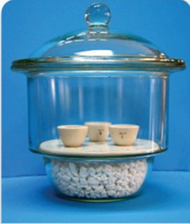
الشكل 1-7 يجفف كلوريد الكالسيوم الهواء من جزيئات الماء. كما يستعمل في المختبر في حفظ المواد الكيميائية من رطوبة الجو.
