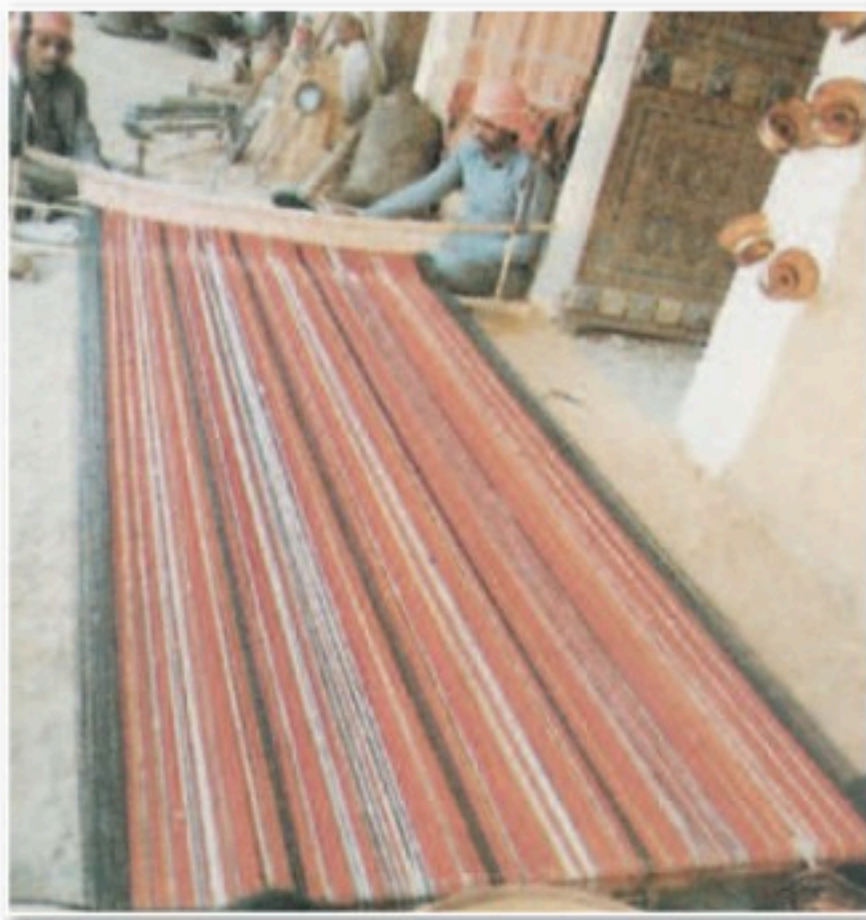
الشكل (٩): نول أرضي لإنتاج قطعة كبيرة.
