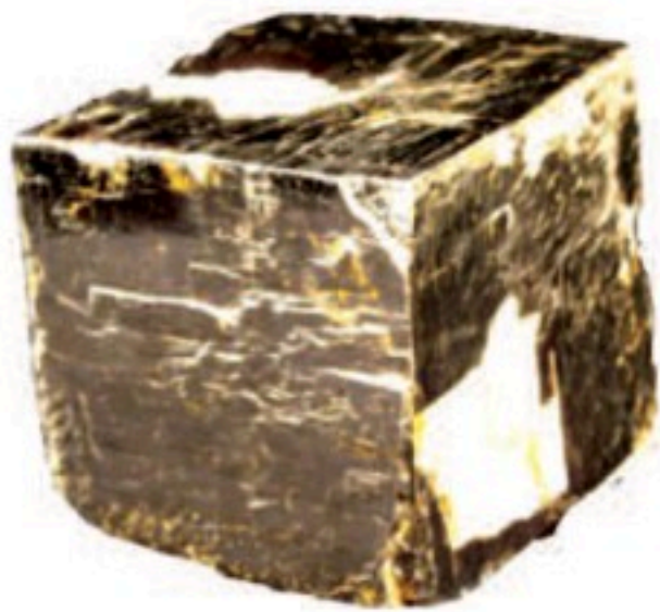
الشكل ٣ معدن البيريت يتكون عادة من بلورات سداسية الأوجه. فسّر لماذا يسمى هذا المعدن بالذهب الزائف؟
