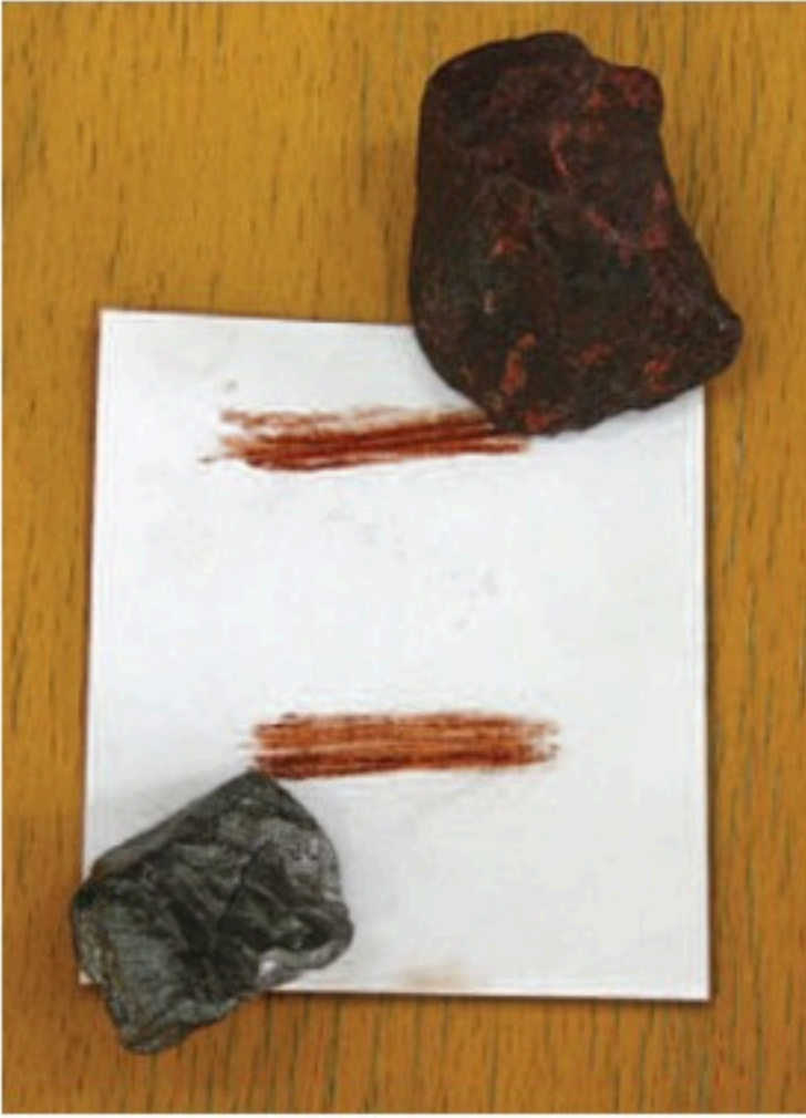
الشكل ٦ المخدش هو لون مسحوق المعدن. معدن الهيماتيت له مخدش بني محمر. وضح كيف تحصل على مخدش معدن؟
