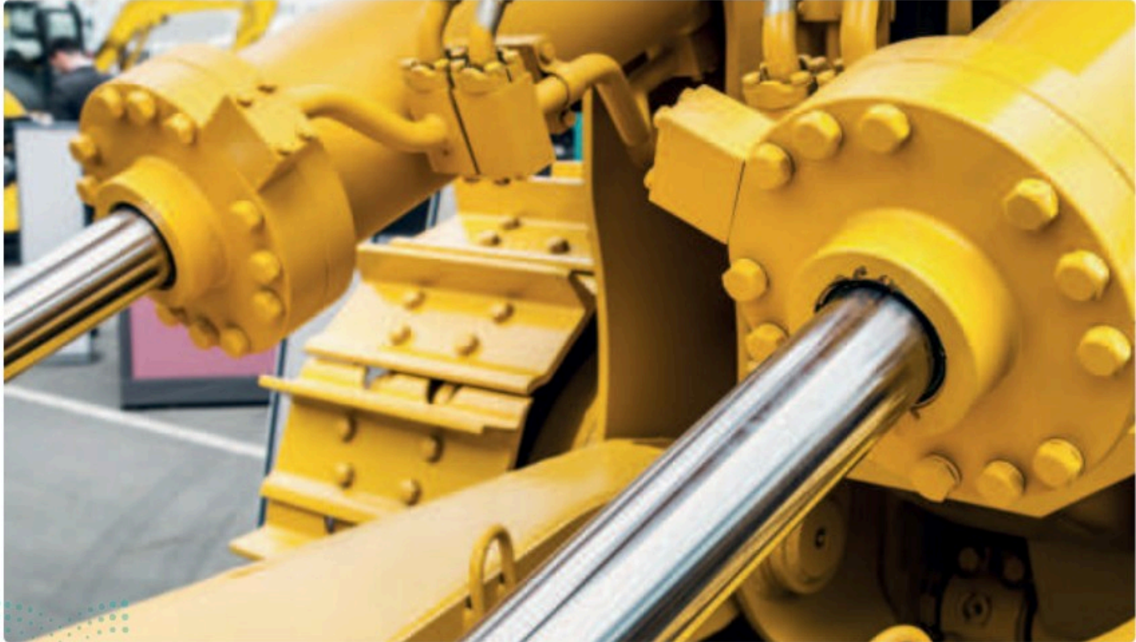
شكل 1.15: نظام مُشغل هيدروليكي (مكبس) للآلات الثقيلة
