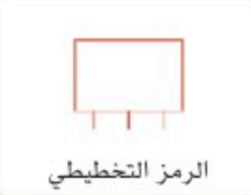
شكل 3.4: مُستشعر درجة الحرارة TMP36
